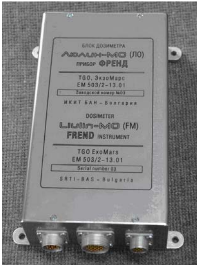
Фиг. 1. Външен вид на българския дозиметър „Люлин-МО“.
