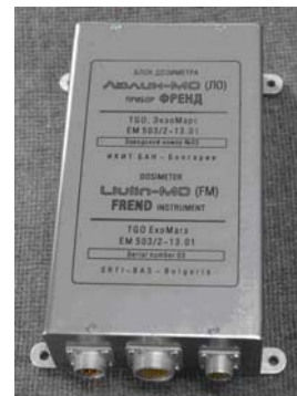
Фиг. 1. Външен вид на българския дозиметър „Люлин-МО“.
